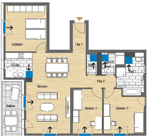
Abluftsystem in einer 4-Zimmer Wohnung (Grundriss: Instone Real Estate) © Aereco
