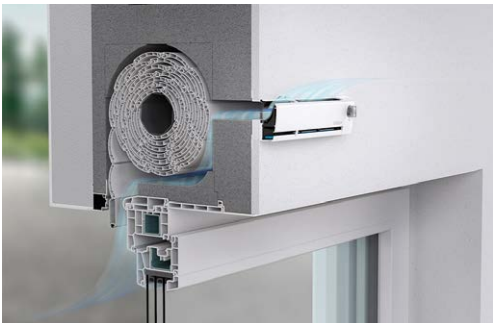
Die feuchtegeführten ALD vom Typ ZUROH sorgen für die nutzerunabhängige Frischluftnachströmung © Aereco
